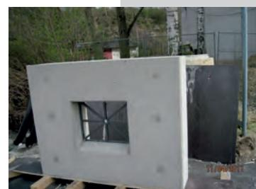
Probestück für die neue Stahlbetonbrüstung
